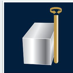
Durch die Rotation der Drahtelektrode wird das Werkstück stets mit der ungenutzten Drahtoberfläche geschnitten. Dadurch wird die geometrische Genauigkeit und die Oberflächenqualität verbessert - ohne Konizitätsausgleich und ohne höheren Drahtvorschub.
